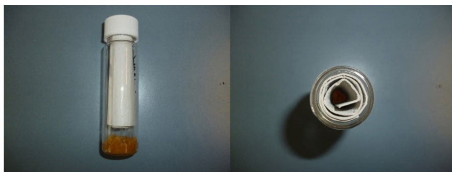
Abbildung A15: Lebensmittel (Marzipan) und Recyclingkarton in Lagerungsgefäß; Seitenansicht, verschlossen (links) und Aufsicht, geöffnet (rechts)
