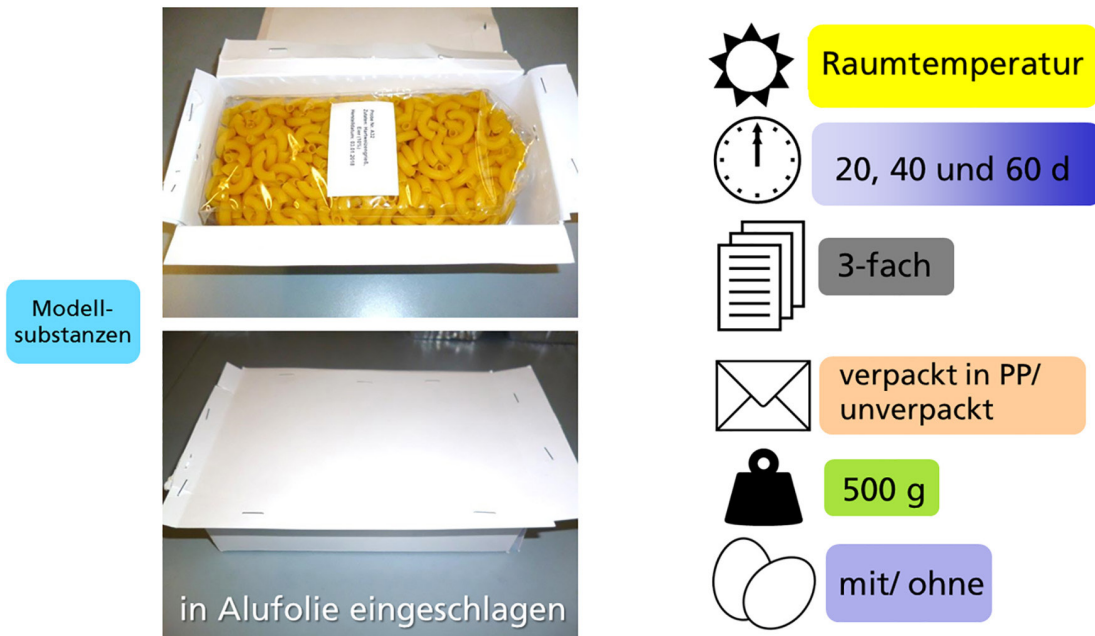
Abbildung 5: Praktisches Beispiel für Migrationstests von Verpackungs-/Lebensmittelkombinationen
